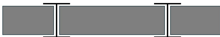
Figur 2.6: Principskiss av en glesspont med I-balkar och skivor emellan.
