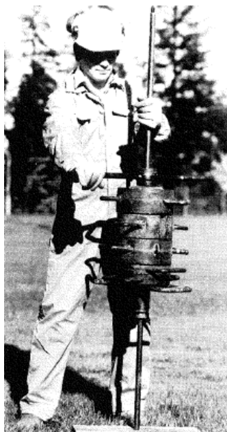
Figur 2-1: Viktsondering som drivs med muskelkraft (Bergdahl, 1984)
