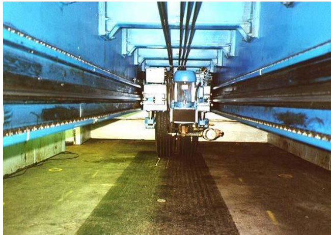
Figur 8-2: HVS-belastning över en flexibel vägkonstruktion (VTI, 2006)
