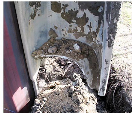
Figur 1: Exempel på bucklad stålspont. Foto t v: Björgúlfsson P, t h: Viking H.
