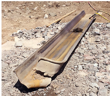
Figur 1: Exempel på bucklad stålspont. Foto t v: Björgúlfsson P, t h: Viking H.
