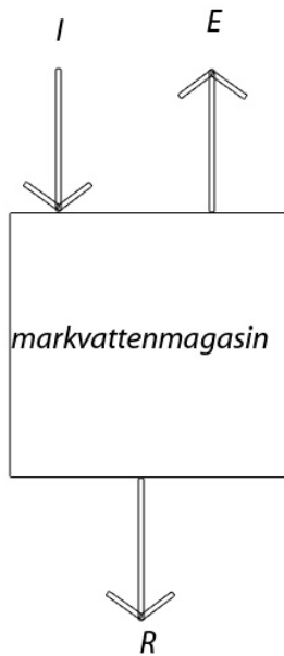
Figur 7.1 – vattenbalans, I = regnmängd, E = avdunstning, R = perkolations
