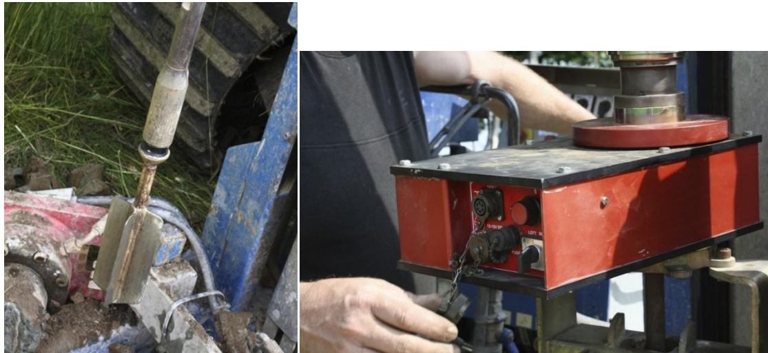
Figur 17 a) Vingdon med glappkoppling utan skyddskåpa b) Elektroniskt instrument för momentpåläggning och datainsamling för vingförsök.
