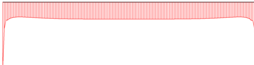
Figur 5.8. Kontaktryckets fördelning mellan platta och sandzon 1 för idealiserat fall.
